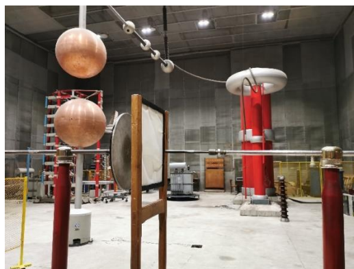
Fig. 5 – Sisteme de electrozi pentru modelarea câmpului electric puternic neuniform în laboratoarele de înaltă tensiune
